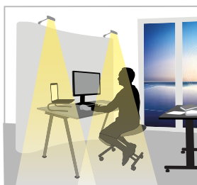
Con scarsa luminosità e con rilevazione del movimento, il 18.51 accende automaticamente le lampade.
